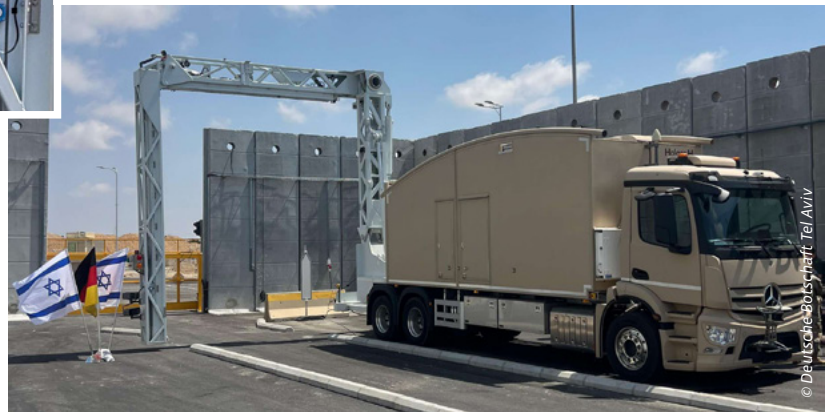
▼ Das Eagle M60 ist ein mobiles Durchleuchtungssystem zur Kontrolle von Fahrzeugen. Damit können die Bediener verbotene Gegenstände, Sprengsätze oder versteckte Personen entdecken.
