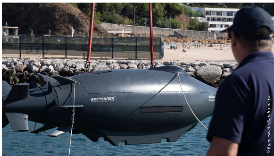
▼ Greyshark ist eine bei REPMUS 2026 getestete, mit KI ausgestattete MultiSensor-Unterwasserdrohne für Tiefsee-Operationen.
