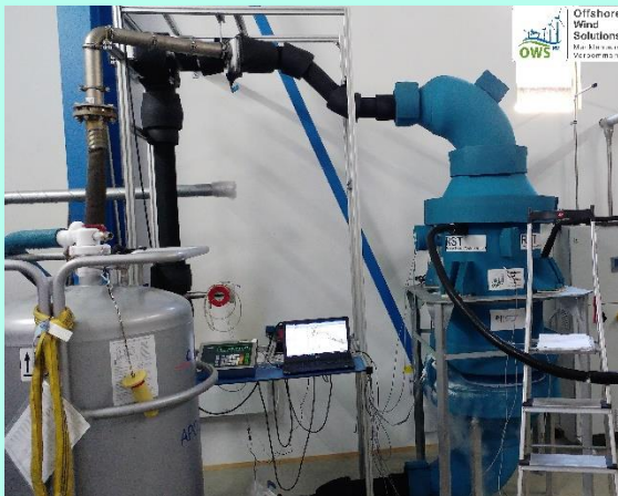
RST Rostock System-Technik entwickelt mit Partnern einen Teststand für den Kryo-Temperatur-Kältespeicher. Foto: OWS-MV
